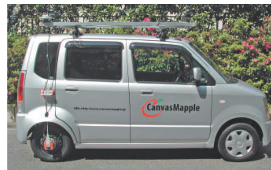
高精度計測システムと高解像度カメラを搭載した車両
